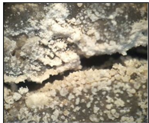
(ب) تصویر ترک ترمیم یافته با بزرگنمایی بیست برابر
