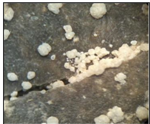
(ج) تصویر ترک با بزرگنمایی چهل برابر
